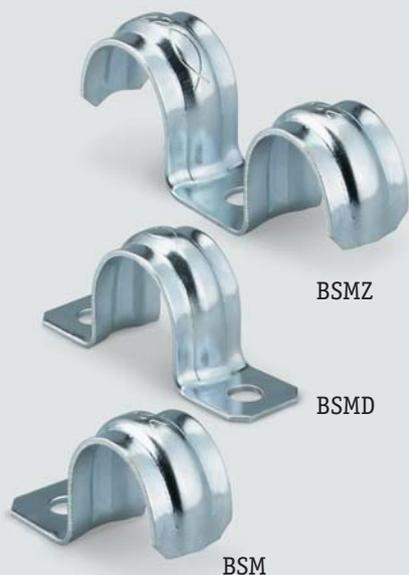
Крепежная скоба **BSM** представляет собой металлический хомут с одним, либо двумя металлическими язычками и с хромированной внешней поверхностью, который служит для надежного крепления жестких и гибких пластиковых труб, стальных труб и проводов.
