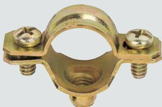
Благодаря открытому с одной стороны отверстию в верхней скобе хомута он может быть легко демонтирован. Для этого надо предварительно расслабить винт с другой стороны примерно на два оборота, после чего слегка отвернуть винт на противоположной открытой стороне и просто сдвинуть верхнюю скобу.
