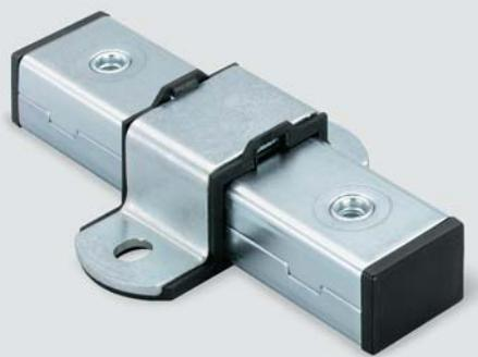
Подвижная опора **SBS** предназначена для монтажа подвесных, горизонтальных или вертикальных трубопроводов к стенам или монтажным шинам. Это одна из разновидностей ползунка **GL**, но более широкого применения - может крепиться непосредственно к металлоконструкциям, стенам и т. п..
