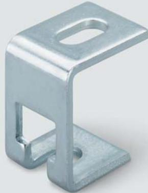
Подвесная скоба **АНВ** служит для регулировки высоты трубопроводов и конструктивных элементов любого типа. С помощью подвесной скобы можно точно выравнивать элементы конструкции и компенсировать допуски. Подвесная скоба подходит для стержней с резьбой M8, M10, M12. В случае применения стержней с резьбой M8 необходимо использовать подкладную шайбу.
