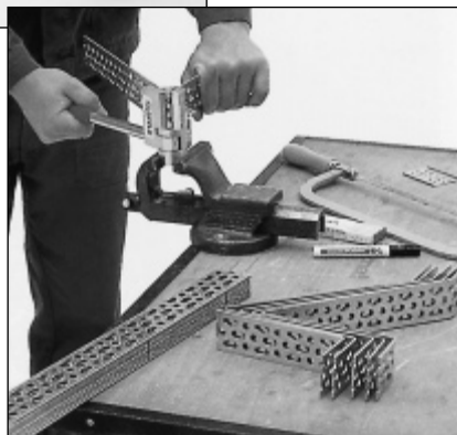
выгибание с использованием тисков
